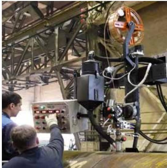
Сварочная головка АДФ-1000 – основа системы для высокопроизводительной автоматической сварки под флюсом.
