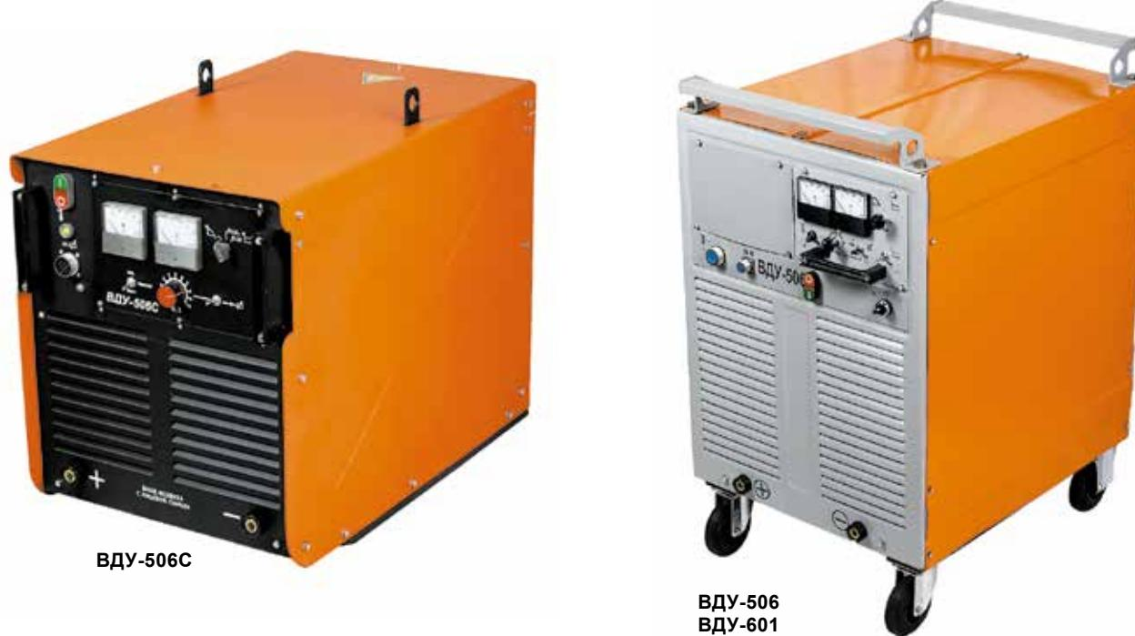
Универсальные выпрямители ВДУ-506, ВДУ-506С и ВДУ-601 предназначены для комплектации полуавтоматов, обеспечивающих сварку малоуглеродистых и низколегированных сталей в защитных газах на постоянном токе. Также ВДУ-506, ВДУ-506С и ВДУ-601 используются в качестве источников для автоматической сварки и ручной дуговой сварки на постоянном токе.
