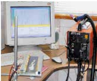
Дуговой тренажёр сварщика ДТС-02 предназначен для тренировки и начального обучения электросварщиков приёмам дуговой сварки покрытым электродом (режим MMA); полуавтоматической сварки электродной проволокой в среде защитных газов (режим MIG/MAG); аргонодуговой сварки неплавящимся электродом с контактным возбуждением дуги (режим TIG). Тренажер позволяет имитировать процесс сварки с помощью реальной малоамперной сварочной дуги.
