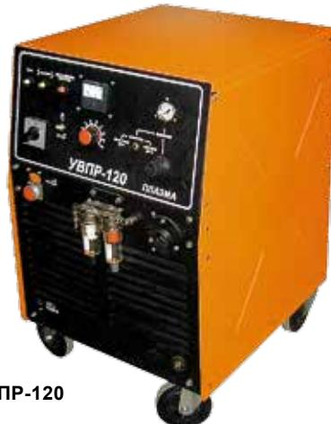
Установки для воздушно-плазменной резки металлов УВПР-0401, УВПР-120 предназначены для резки листовых и профильных конструкций, выполненных из чугуна, малоуглеродистых, углеродистых, низколегированных и легированных сталей, латуни, меди, алюминия и его сплавов.
