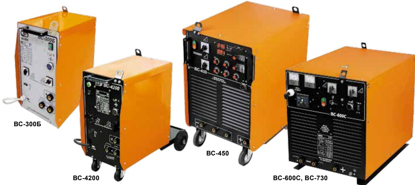
Серия выпрямителей со ступенчатым регулированием ВС предназначена для комплектации полуавтоматов, обеспечивающих сварку малоуглеродистых и низколегированных сталей в защитных газах на постоянном токе. ВС-600С и ВС-730 также применяются в качестве источников для автоматической сварки.
