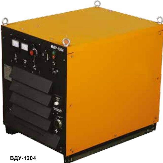
Выпрямитель ВДУ-1204 в комплекте со сварочным автоматом предназначен для сварки под слоем флюса изделий из углеродистых и легированных сталей, а также может быть использован для воздушно-дуговой резки (строжки) угольным электродом в режиме падающей внешней характеристики.
