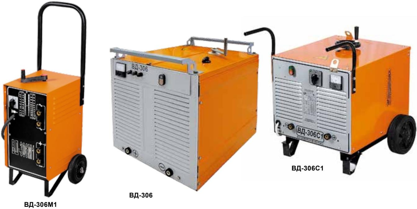
Выпрямители ВД-306М1, ВД-306, ВД-306С1 предназначены для ручной дуговой сварки малоуглеродистых, низколегированных и коррозионностойких сталей. ВД-306, ВД-306С1 обеспечивают сварку на постоянном токе, ВД-306М1 – на постоянном и переменном токе.
