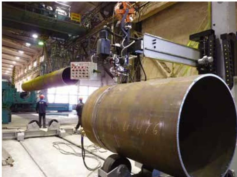
Сварочный комплекс на базе АДФ-1000
