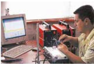
Тренажер управляется при помощи персонального компьютера. Программа управления тренажером, WWSim разработана для операционной системы Microsoft Windows 2000, XP. Установка граничных значений контролируемых параметров (длина дугового промежутка, тепловложение, угол наклона электрода) осуществляется через окно параметров. Нарушения граничных значений контролируемых параметров сопровождаются звуковым сигналом.
