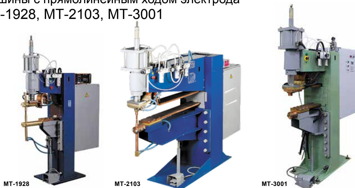
Машины MT-1928, MT-2103 и MT-3001 предназначены для точечной сварки переменным током деталей из легированных и нержавеющих сплавов, легированных сталей, титановых сплавов, алюминиевых сплавов и крестообразных соединений стержней арматуры. Машины рассчитаны на интенсивные нагрузки в промышленных условиях.
