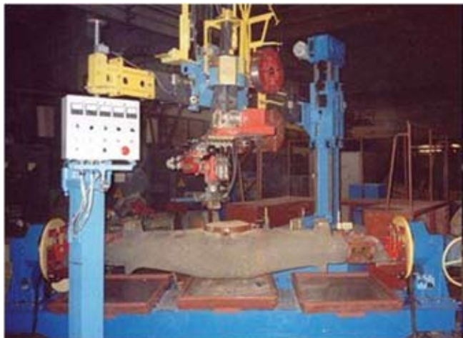
Рис.1 Комплекс оборудования КДНФ4-1200 для 4-х электродной наплавки надрессорных балок ж/д вагонов. Производительность процесса до 60 кг металла в час. Удельное энергопотребление на 1кг наплавленного металла до 3-х кВт –час. Себестоимость 1-го кг наплавленного металла – 200 рублей. Сварочные материалы: проволока СВ-08ХГ2СМФ диаметром 2,0 мм, флюс АН-60 или ФКН-1/55.
