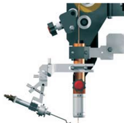
Сенсор следящей системы установленный на сварочную головку
