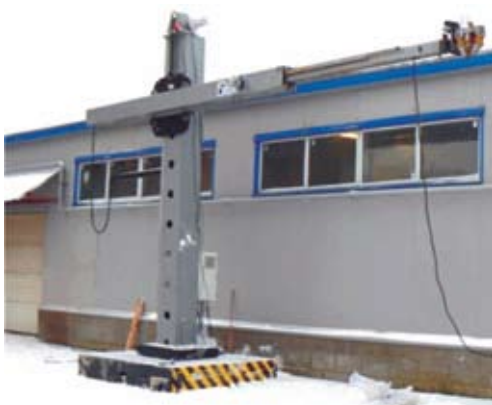
Колонна малой грузоподъемности (с выдвижной балкой)
