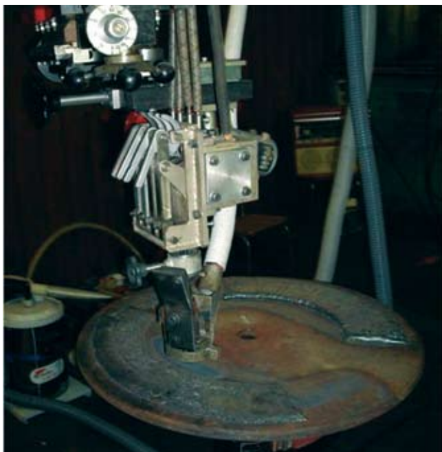
Рис. 2. 4-х электродная наплавка кольцевой поверхности. Ширина наплавленного слоя – 100 мм, толщина 4,0 мм. Наплавка выполняется за один проход.
