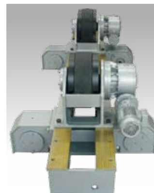
Модификация роликовой опоры для установки на рельсовый путь
