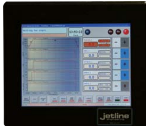
Цветной сенсорный экран управления контроллера (диагональ 15 дюймов)
