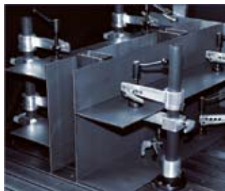
Фиксация заготовок листовых конструкций
