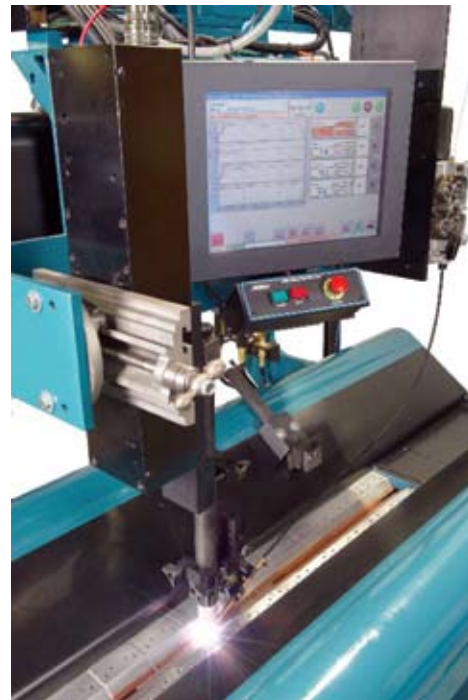
Экран управления контроллера установлен на системе для сварки продольных швов
