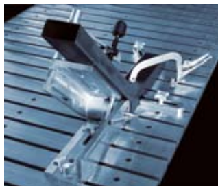
Фиксация заготовок произвольной формы
