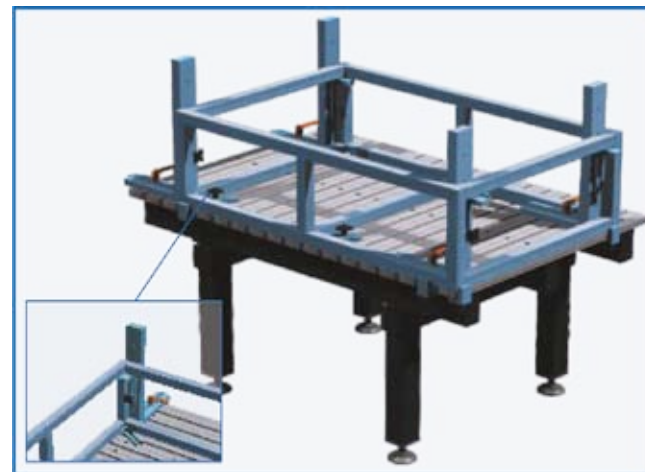
Вариант фиксации для сварки рамных каркасов размером 1.500 x 1.000 x 400 мм (передняя и задняя стороны каркаса предварительно изготовлены в виде рам).
