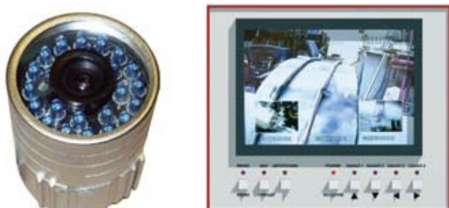
Видео камера с светодиодной подсветкой и монитор с функцией масштабирования, стоп кадра и возможностью подключения до 6 камер
