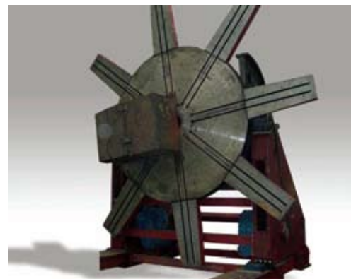
Тяжелый одностоечный позиционер на 80 тонн
