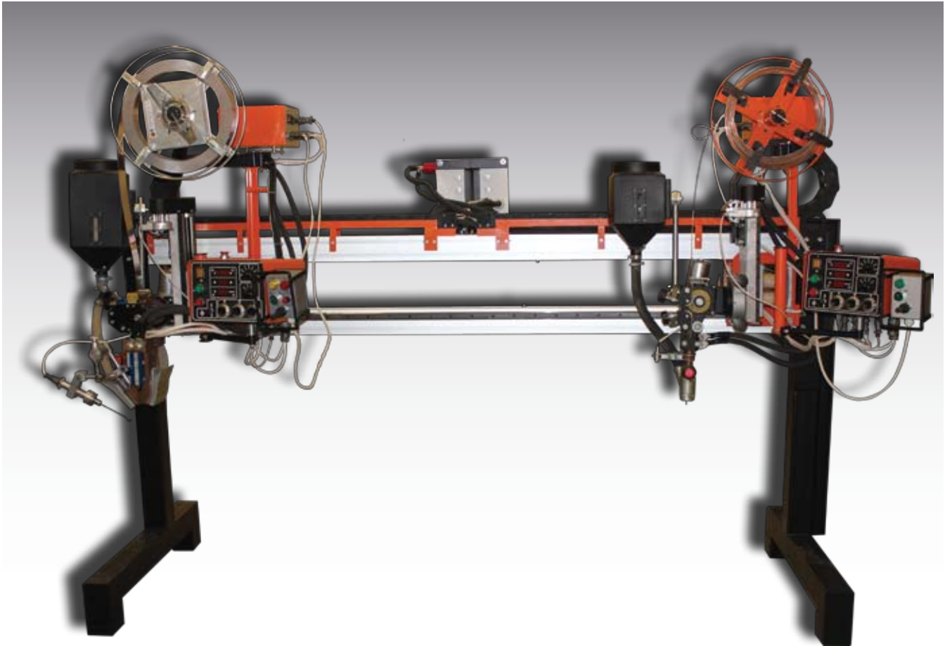
Головка АДФ-1000 в составе автоматизированного комплекса для сварки и наплавки
