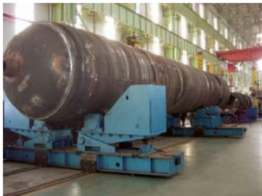
Опорные роликовые вращатели на 1200 тонн с системой антидрейфа
