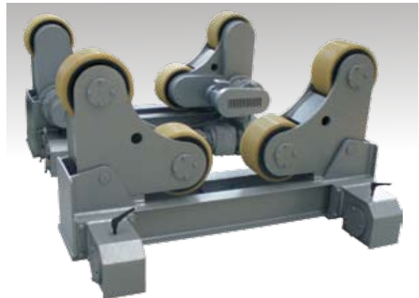
Модификация вращателей для установки на рельсовый путь
