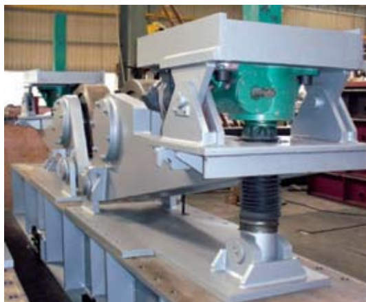
Опорные роликовые вращатели на 1200 тонн с системой антидрейфа
