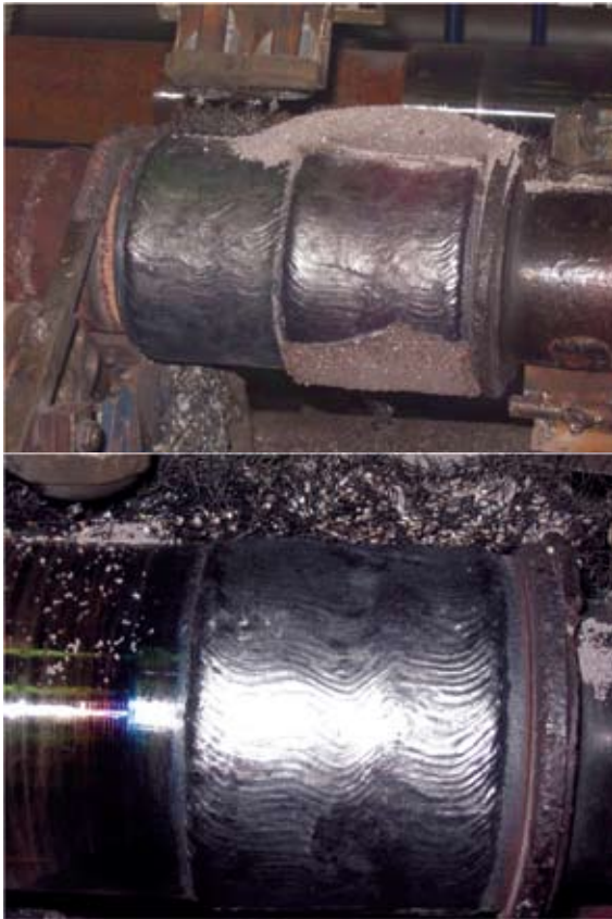
Рис.4. 2-х электродная наплавка под флюсом за- мков бурильных труб на установке УДНФ3-1200. Ширина наплавленного слоя – 120 мм, толщина – 3,0 мм
