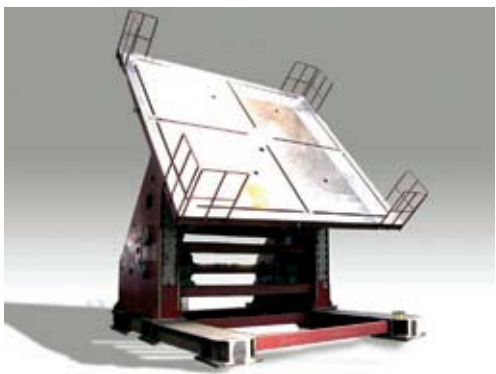
Тяжелый одностоечный позиционер на 100 тонн
