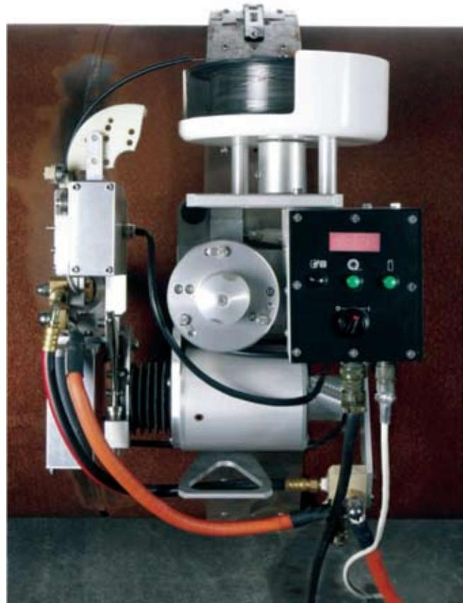
поворотных кольцевых стыков в нефтегазовом комплексе, где сварка ведется двумя головками. В экстренных случаях возможно использование двух левых или двух правых головок на одном поясе.
